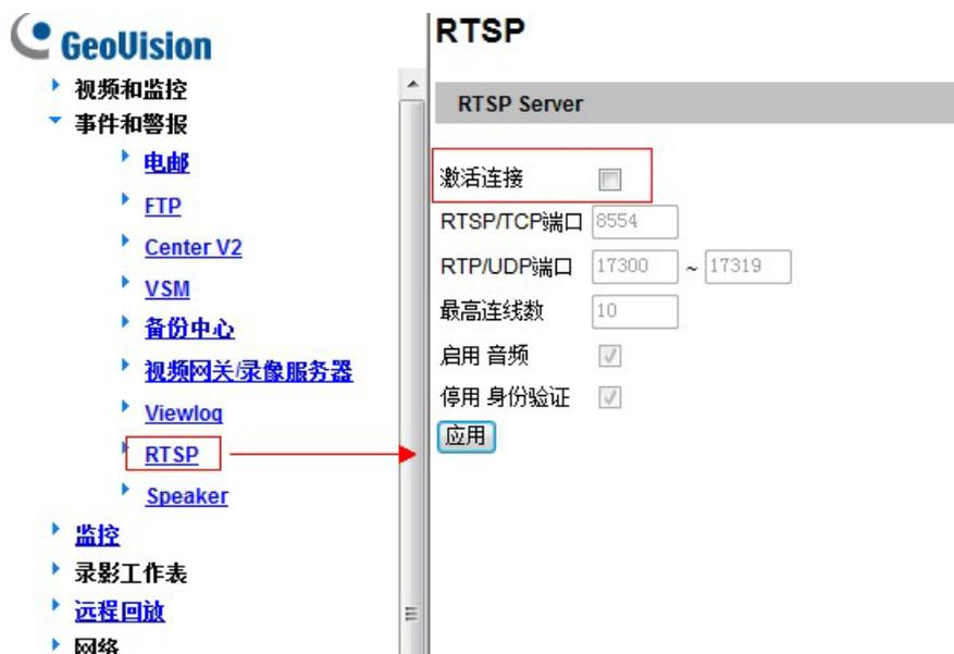
GV 的 RTSP 命令格式：`rtsp://<IP of the GV-IP cam:8554/<CH No.>.sdp`
